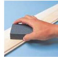
**2** サンドペーパー #240以上で研磨し、ツルツル面に仕上げして下さい。
