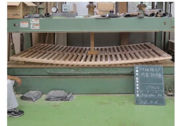
面荷重試験 1500N (約 150kg)
