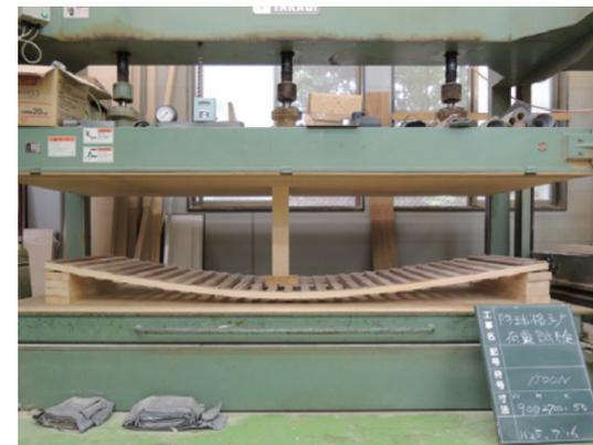
面荷重試験 1500N (約 150kg)
